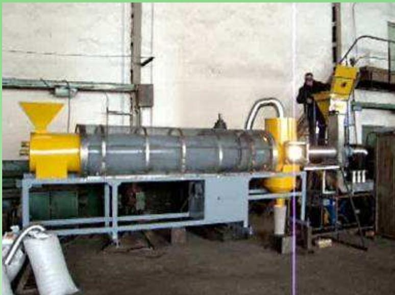
Работы по газификации чистых органических материалов - сепарированных, сухих (влажность до 15 %) твердых бытовых отходов \*, проводились на опытной установке плазменной газификации, производительностью 100 кг/час. Установка была укомплектованной плазменной горелкой мощностью 30 кВт, работавшей в непрерывном режиме в течении 240 часов,
