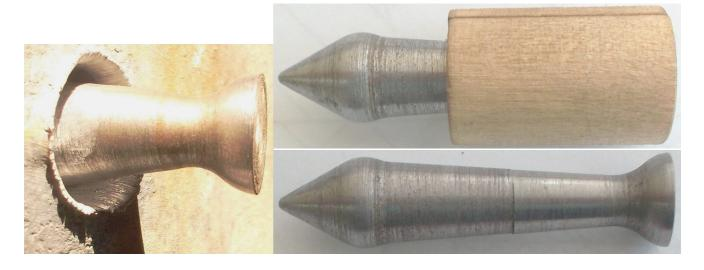
Пуля охотничья – модификация боевой калибра 12,7 мм. Возможность изготовления пуль боевых и охотничьих на одном и том же оборудовании – важное преимущество на случай мобилизационного периода.
